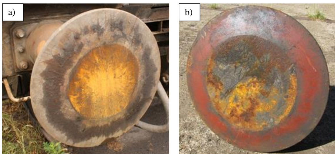
Rys. 2 Spłaszczenie tarczy zderzakowej wskutek zużycia ściernego
