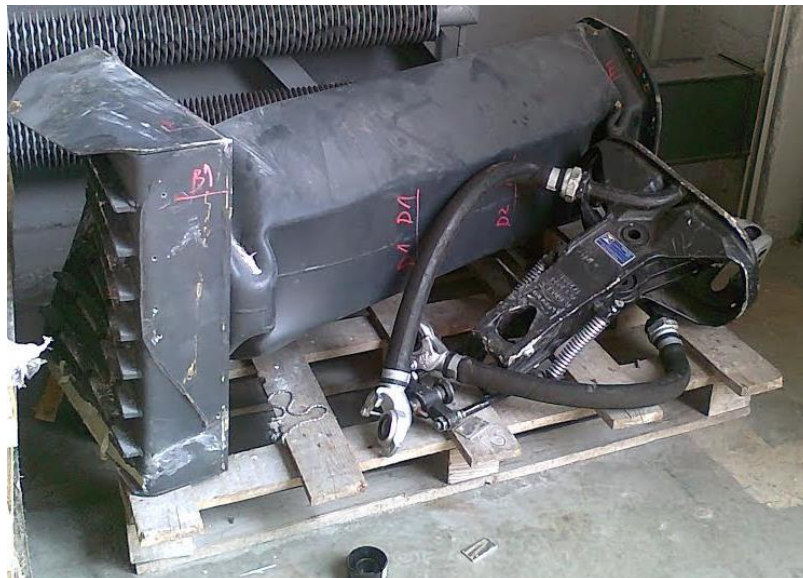
Rys. 7 Zdeformowany element konstrukcyjny pojazdu odpowiedzialny za pochłanianie energii zderzenia
