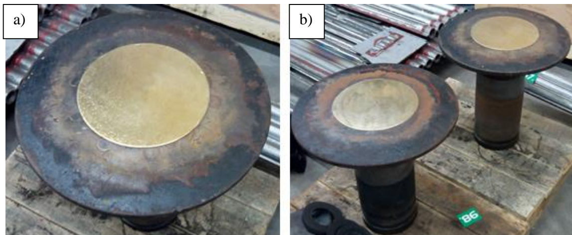
Rys. 69 Tarcze zderzakowe z napoinami brązu aluminiowego
