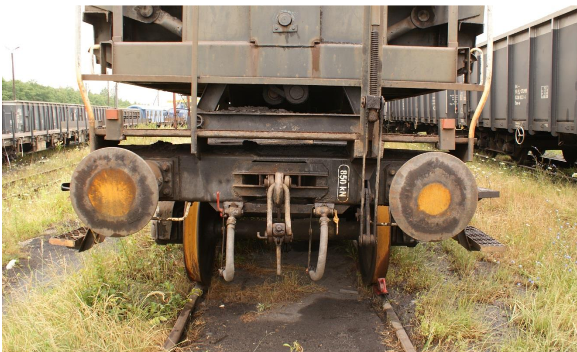
Rys. 16 Skorodowane powierzchnie zewnętrzne tarcz zderzakowych
