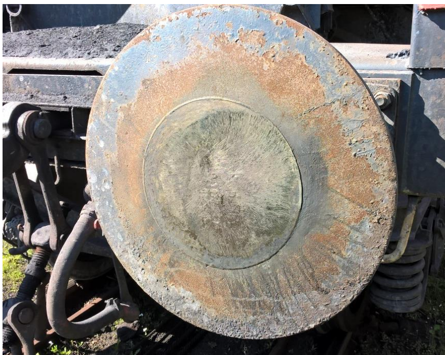
Rys. 74 Tarcza zderzakowa pokryta brązem aluminiowym podczas kolejnych pomiarów w trakcie badań eksploatacyjnych
