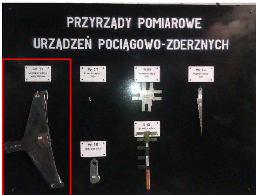
Rys. 15 Przyrządy pomiarowe do urządzeń ciągowych i zderzakowych. Na czerwono zaznaczono przyrząd do pomiaru spłaszczenia tarczy zderzaka
